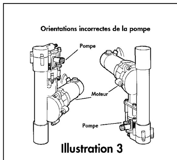
directement au-dessus du mécanisme d'entraînement, celui-ci et/ou le moteur électrique peuvent être endommagés (**illustration 3**, à gauche).
