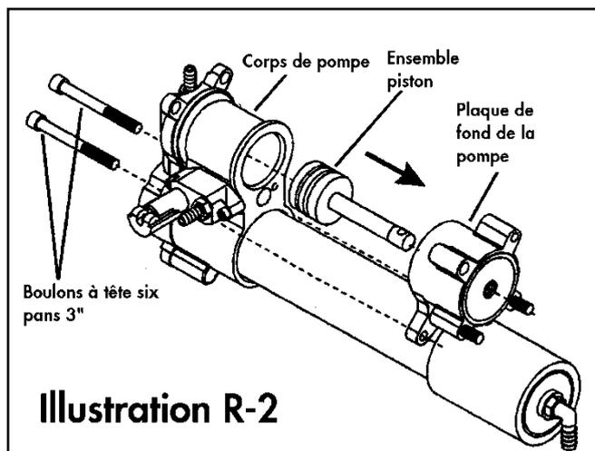
4. Ôtez les deux boulons à tête six pans 3" à l'aide d'une clé Allen 1/4". Détachez la plaque de fond de la pompe et l'ensemble piston du corps de pompe (voir **illustration R-2**).
