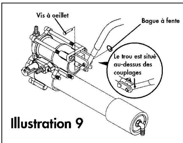
9. Actionnez la poignée de pompe d'avant en arrière aussi loin que vous le pouvez dans les deux sens. Pompez à la vitesse d'environ un cycle complet toutes les deux secondes (une seconde dans chaque direction). C'est approximativement la vitesse à laquelle la pompe fonctionne en mode motorisé. Ne pompez pas trop vite !
